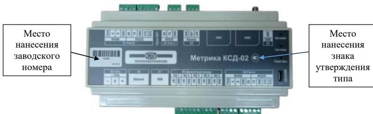
Рисунок 3 – Места нанесения на корпус УСПД заводского номера и знака утверждения типа средств измерений
